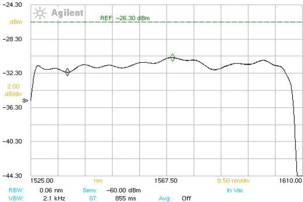
(5) L-波段标准型，输出 50mW
