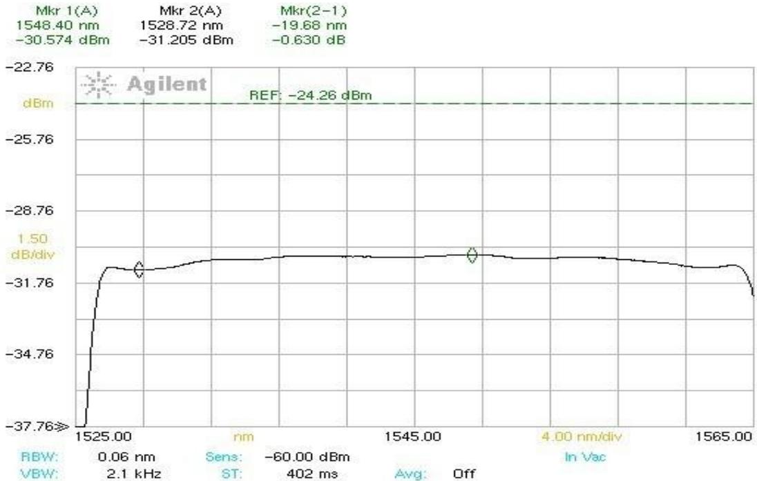
(3) C+L-波段标准型, 输出: 200mW
